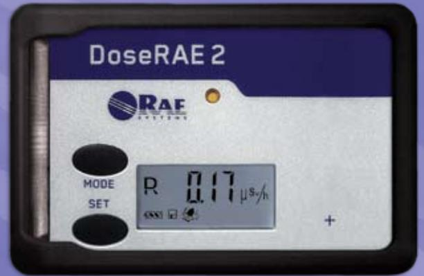
DoseRAE 2 はコンパクトで、直接表示型の、警報付き電子パーソナル放射線検出器です。ダイオードとシンチレーション結晶によってX線やガンマ線を検出し、個人が受ける線量や線量率をリアルタイムで表示します。放射線線量率をリアルタイムでモニタリングすることにより、放射線が発生した場合に迅速に対応し、放射線暴露を減らすことができます。この検出器は線量当量と線量当量率も測定するため、線量計としての機能も果たします。さらに、放射線暴露と暴露率も測定するので、光子放射に対する緊急時対応要員の被ばく制御にも役立ちます。
